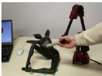
Elaborazione digitale del modello con HandyScan.
