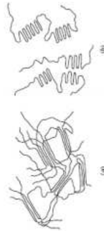
Figura 10.16 Due possibili disposizioni di cristalli in materiali termoplastici parzialmente cristallini: (a) modello della micella frangente, (b) modello della catena ripiegata. (Da F. Rodighiero, "Principles of Polymer Systems," 2a ed., McGraw-Hill, 1967, p. 42.)
